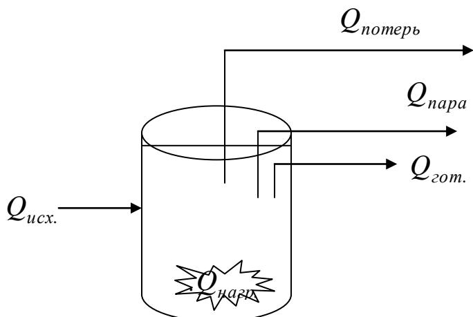
$Q_{\text{нагр.}}$  – теплота, выделяемая нагревательным устройством;  $Q_{\text{учс.}}$  – теплота, вводимая с исходным продуктом;  $Q_{\text{вом.}}$  – теплота, выводимая с готовым продуктом;  $Q_{\text{потерь}}$  – потери теплоты;  $Q_{\text{нара}}$  – теплота, выводимая с образовавшимся паром.
