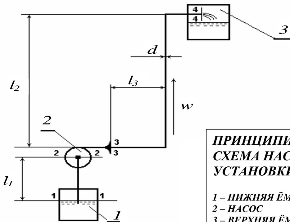
**Исходные данные:** геометрические характеристики – длины участков трубопровода  $l_1$ ,  $l_2$ ,  $l_3$  и  $d$  (внутренний диаметр трубопровода); вид, температура ( $t$ ) и массовый расход ( $m$ ) продукта; давление над поверхностью жидкости в верхней ( $P_4$ ) нижней ( $P_1$ ) ёмкостях, КПД насоса ( $\eta$ ).
