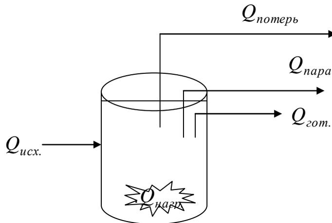
$Q_{\text{нагр.}}$  – теплота, выделяемая нагревательным устройством;  $Q_{\text{исх.}}$  – теплота, вводимая с исходным продуктом;  $Q_{\text{гот.}}$  – теплота, выводимая с готовым продуктом;  $Q_{\text{потерь}}$  – потери теплоты;  $Q_{\text{пара}}$  – теплота, выводимая с образовавшимся паром.
