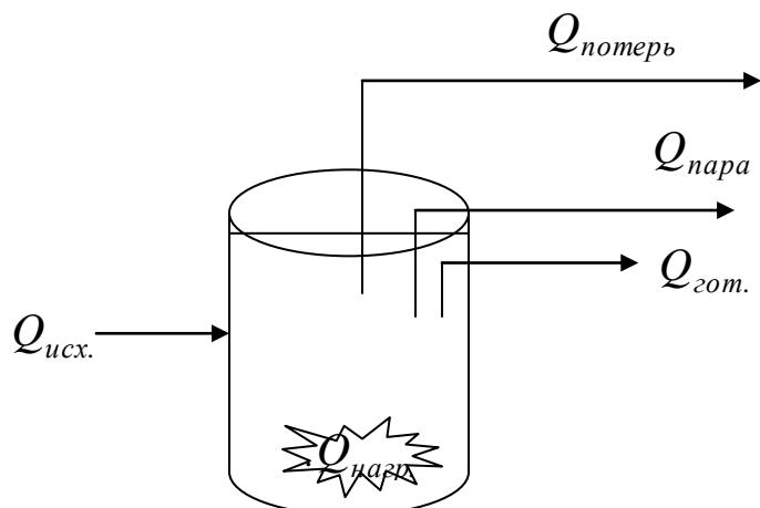
$Q_{\text{нагр.}}$  – теплота, выделяемая нагревательным устройством;  $Q_{\text{учс.}}$  – теплота, вводимая с исходным продуктом;  $Q_{\text{вом.}}$  – теплота, выводимая с готовым продуктом;  $Q_{\text{номерь}}$  – потери теплоты;  $Q_{\text{нара}}$  – теплота, выводимая с образовавшимся паром.
