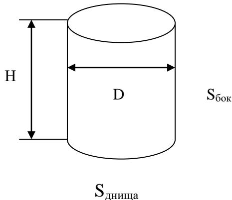
$D$  – диаметр,  $H$  – высота,  $S_{\text{бок.}}$  – боковая поверхность,  $S_{\text{днища}}$  – поверхность днища.
