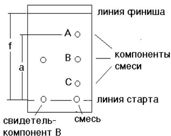
Рис. 5.2. Разделение компонентов сложной смеси методом ТСХ
