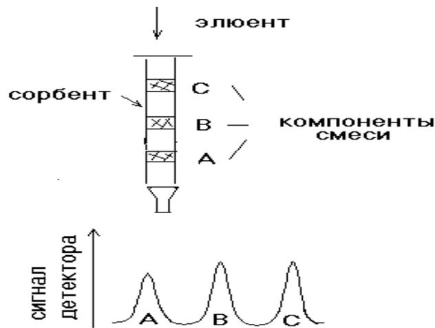
Рис. 5.1. Общая схема разделения смеси на индивидуальные компоненты методом колоночной хроматографии.
