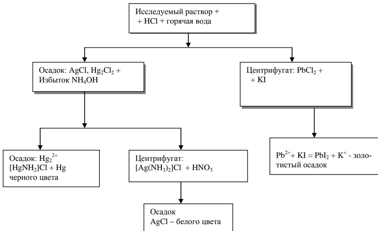
Рис. 1.1. Схема определения катионов II аналитической группы кислотно-основной классификации
