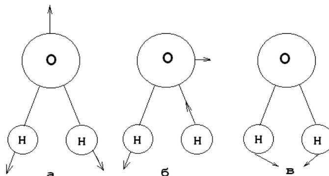
Рис. 7.7. Колебания в молекуле воды: а) валентные симметричные ( $\nu_s$ ); б) валентные несимметричные ( $\nu_{as}$ ); в) деформационные ( $\delta$ ).
