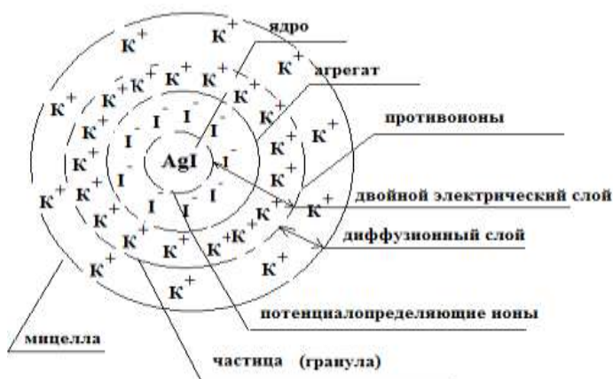
Рис. 8.1. Мицелла золя иодида серебра, полученного по реакции \text{AgNO}_3 + \text{KI} при избытке KI.
